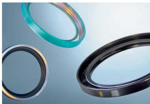
Les joints d'arbres radiaux assurent l'étanchéité des arbres en rotation. Maintenus dans le logement par un ajustage serré, ils agissent de manière radiale et assurent de ce fait une étanchéité statique. La lèvre d'étanchéité dynamique permet une étanchéité radiale de l'arbre en rotation.
